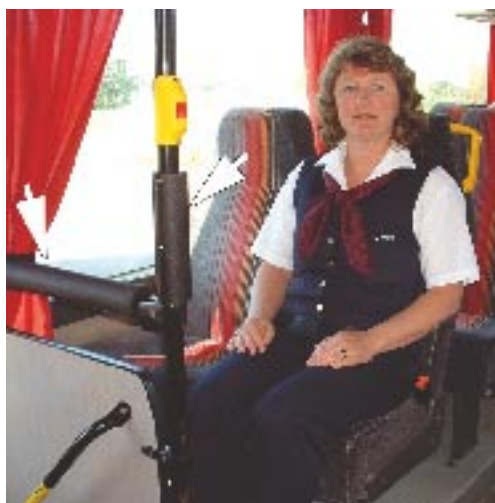
Pilarna markerar islagsytor som försetts med stötdämpande skydd.
